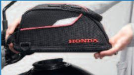
Von oben vertikal an den Tankring heranführen ...
